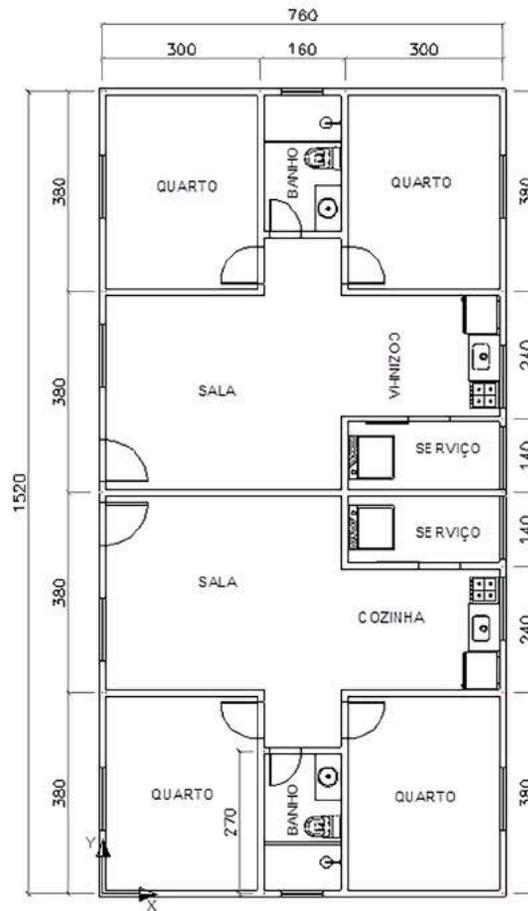
Figura 6.4 – Arquitetura do pavimento térreo e superior (dimensões em cm)
