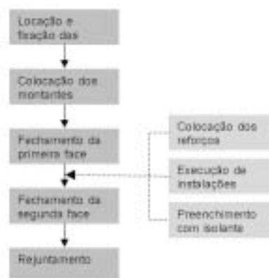
Figura 43 - Seqüência de montagem de divisórias em chapas de gesso acartonado (a partir de TANIGUTI, 1999).
