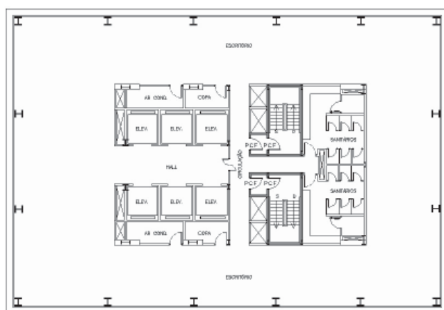
Figura 4.11 Escadas enclausuradas de um edifício.
