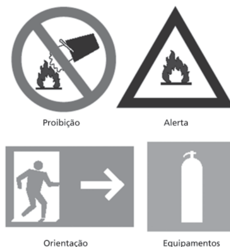
Figura 2.18 – Sinalização de emergência
