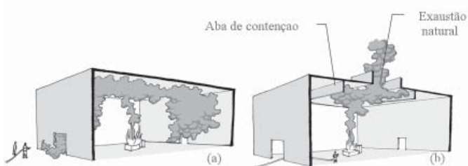
Figura 2.14 – Propagação da fumaça: (a) quando não existem medidas de controle; (b) quando medidas de controle de movimento da fumaça foram previstas.
