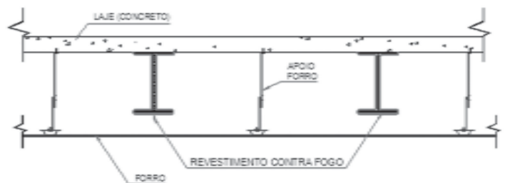
Figura 5.4 Vigas com revestimento contra fogo ocultadas por forro.
