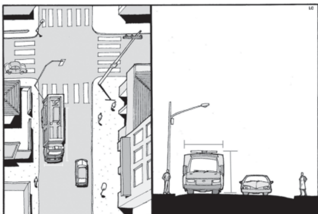
Figura 2.26 – Características das vias de acesso para veículos de bombeiro
