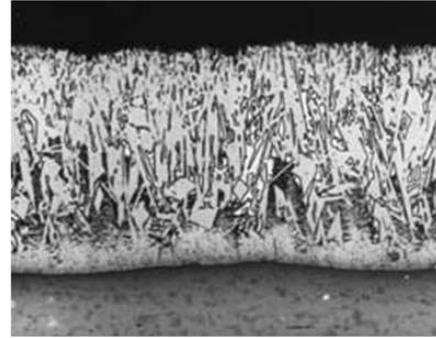
Figura 32: Efeito do silício no desenvolvimento de películas mais espessas na galvanização a quente – o Efeito Sandelin.
